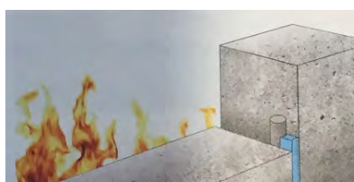
E Junta simples com silicone FP 402
