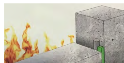
C Junta simples com acrílico FP 401
