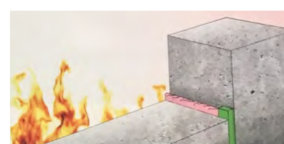
H Junta combinada com acrílico FP 401 e espuma FP 404
