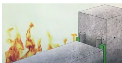
B junta dupla com Acrílico FP 401
